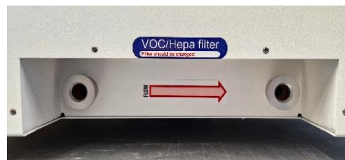
Abbildung 12.1 Der Fließrichtungspfeil am MIRI® Mehrraum-IVF-Inkubator
