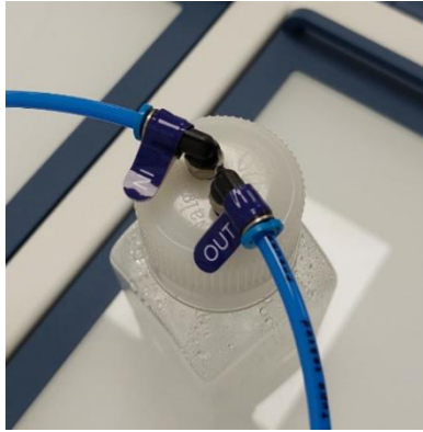
Abbildung 23.1 Schlauchanschluss an der Befeuchtungsflasche und dem MIRI® Humidity Mehrraum-IVF-Inkubator
