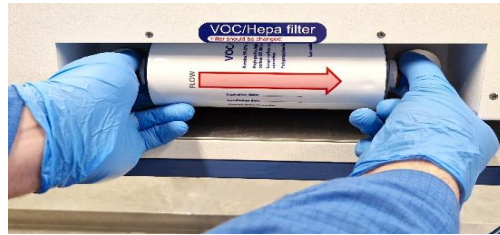
Abbildung 12.2 Verfahren zum Einsetzen und Entfernen des LCKW/HEPA-Filters
