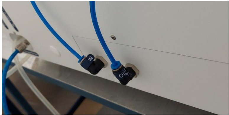
Abbildung 23.1 Schlauchanschluss an der Befeuchtungsflasche und dem MIRI® Humidity Mehrraum-IVF-Inkubator
