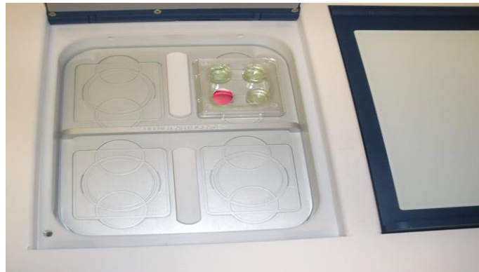
Abbildung 20.3 4er-Mehrfach-Schale mit 3 Puffern und Medium
