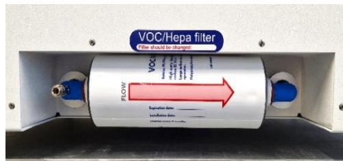
Abbildung 12.3 Korrekt installierter LCKW/HEPA-Filter
